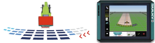
Jeśli szerokość rozsiewu się zmniejsza, to podczas np. ostatniego przejazdu, sekcje automatycznie zamykają się w zależności od szerokości pozostałej do rozsiewu (na ilustracji powyżej 3 sekcje po prawej stronie są zamknięte).
