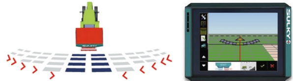
Na końcu pola o prostej linii, przed całkowitym zamknięciem warstwy, tylko 2 sekcje w środku pozostają otwarte. Precyzja rozsiewu warstwy o zakrzywionym kształcie jest wtedy maksymalna.
