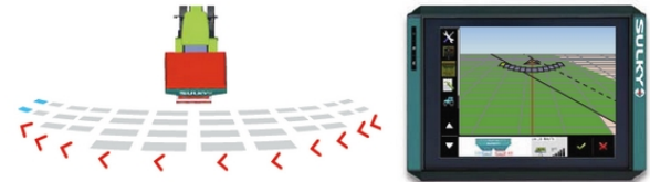
Tylko jedna skrajna sekcja jest otwarta podczas kończenia rozsiewu na klinie pola.
