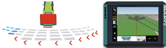
Prawa strona zamknięta, progresywnie zamykanie sekcji po lewej stronie, od środka do kierunku na zewnątrz.
