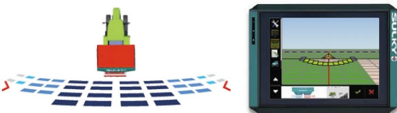
Dojeżdżając do końca pola o prostej linii, sekcje progresywnie zamykają się od zewnątrz do środka, respektując tym samym rzeczywiste, zakrzywione rozłożenie warstwy rozsiwanego nawozu!
