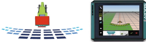
ECONOV w wersji z ISOBUS steruje 12 równymi sekcjami rozsiewu jakkolwiek będzie ustawiona szerokość robocza (powyżej pokazano pełną szerokość roboczą z otwartymi 12 sekcjami).
